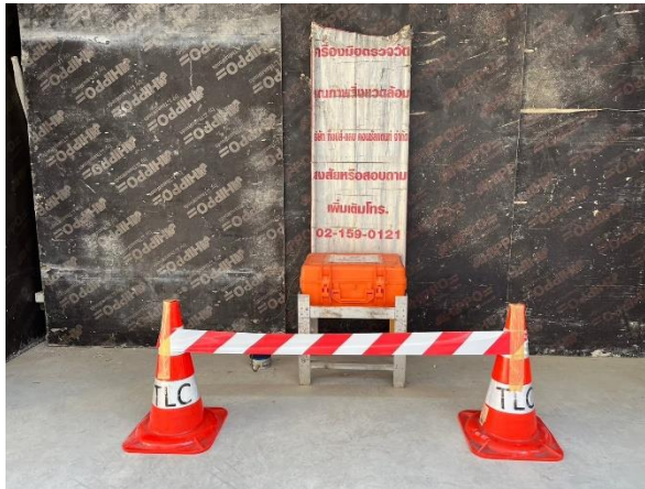
รูปที่ 3.5.3-1 การตรวจวัดความสั่นสะเทือน บริเวณพื้นที่โครงการ (ก่อนกำแพงกันเสียง) ด้านทิศใต้
