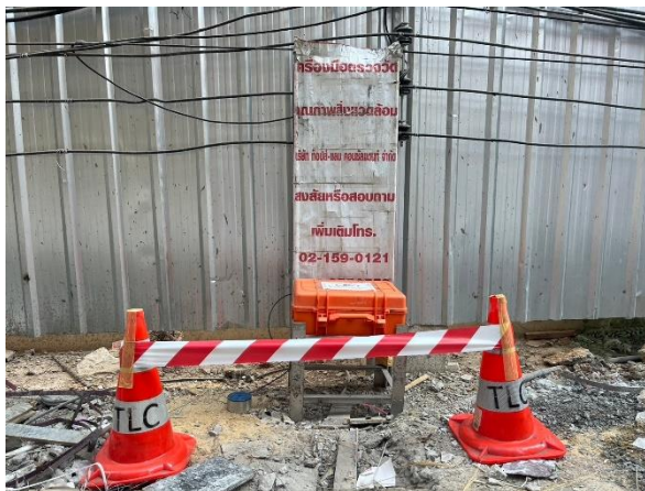
รูปที่ 3.5.3-2 การตรวจวัดความสั่นสะเทือน บริเวณพื้นที่โครงการ (หลังกำแพงกันเสียง) ด้านทิศใต้
